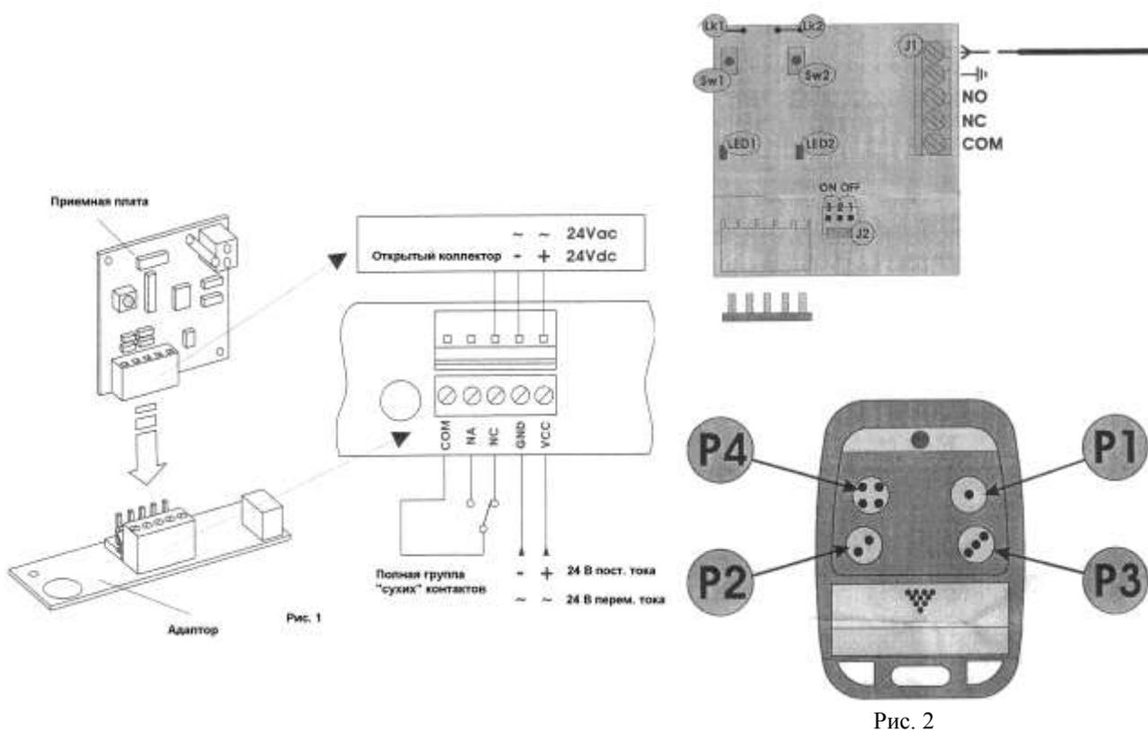
контактами реле на приемной плате.
